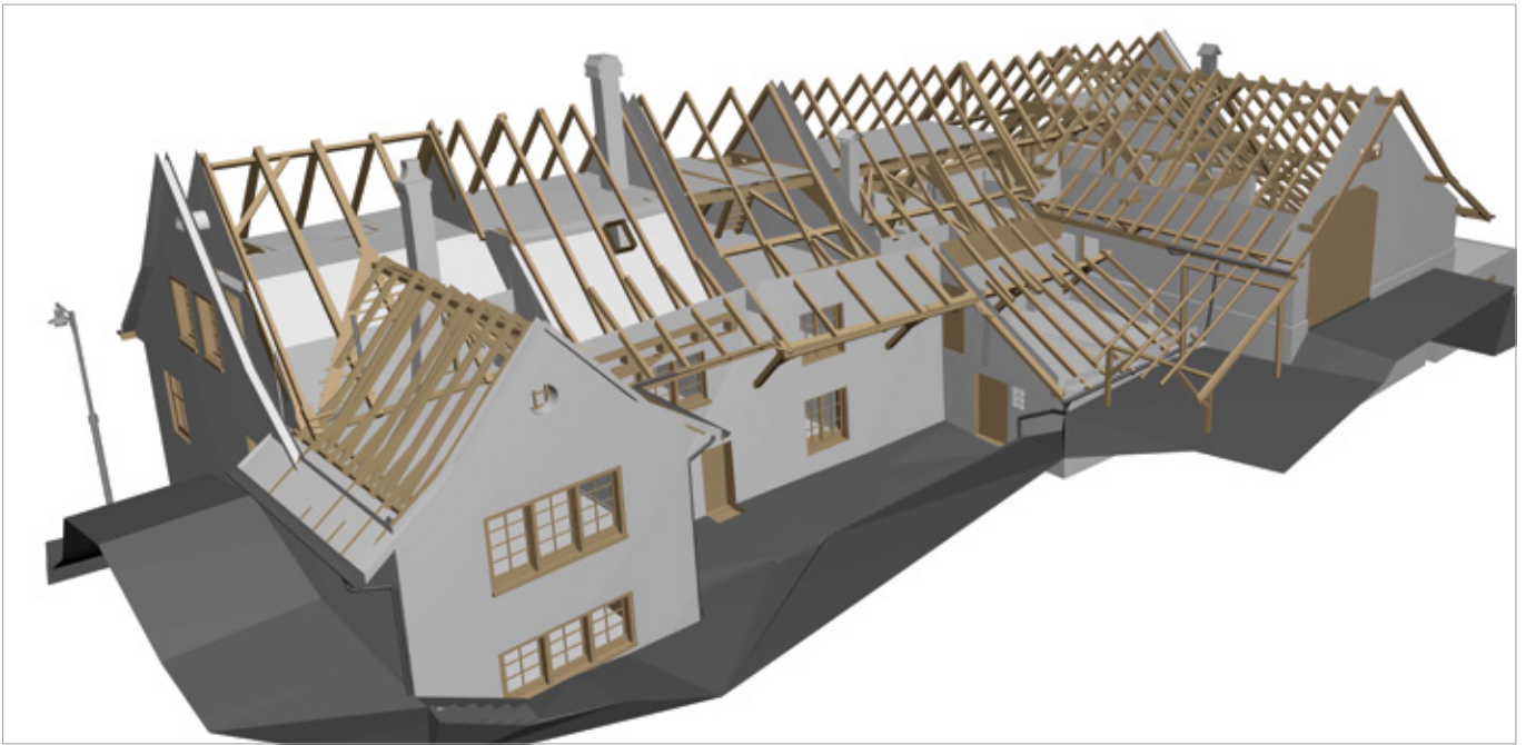
Verformungsgetreues 3D-Modell eines Bauernhauses mit vollständiger Dachkonstruktion
