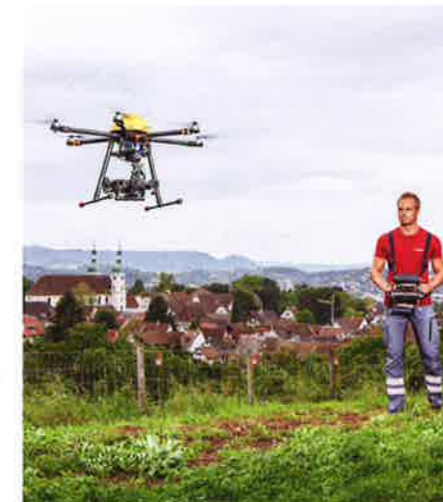
Drohnen und Multikopter erlauben die präzise Vermessung auch an schwer zugänglichen Orten. Bild: Jermann
