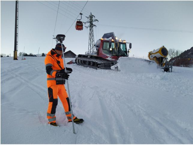
Einmessung Hilfspunkte zur Georeferenzierung mittels GNSS
