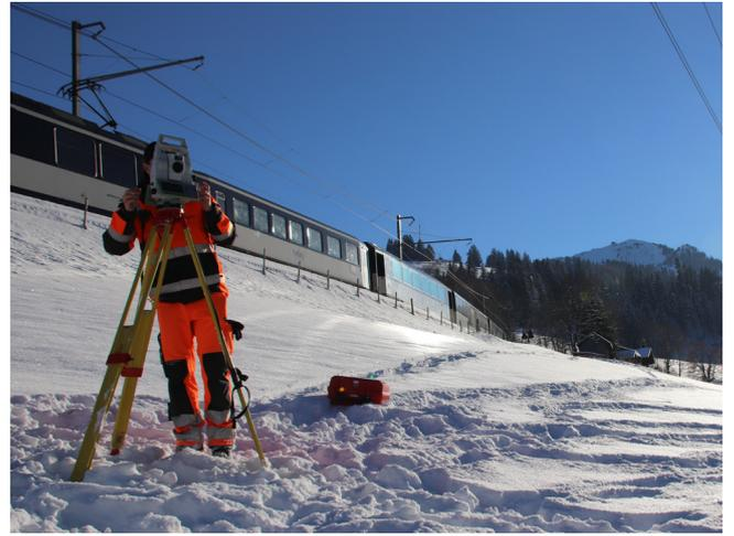
Einmessung Scantargets zur relativen Verknüpfung der einzelnen Scans
