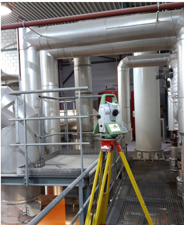
Aufnahme der Technikgeometrien mittels 3D-Laserscanner und Tachymeter
