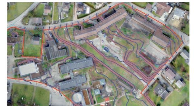
Berechnetes Terrainmodell mit Höhenkurven, hinterlegt mit Orthofoto
