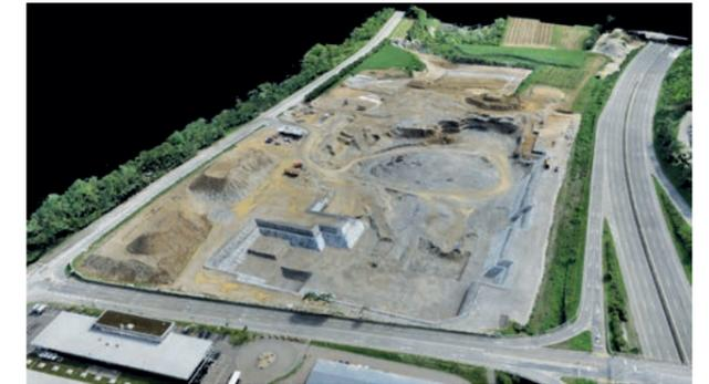
3D-Punktwolke eines Aushubs als Basis zur Volumenberechnung
