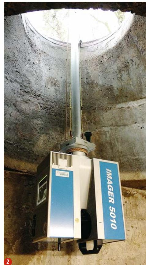
eine sogenannte Punktwolke generiert, aus der später alle gewünschten Informationen wie beispielsweise Kammergeometrie, Lage, Höhe und Dimension der Ein-, Ausläufe sowie Überfallkanten ermittelt werden können. Der grosse Vorteil der Scanning-Technologie ist, dass die Schächte nicht begangen werden müssen und in sehr kurzer Zeit vollständig mit hoher Genauigkeit erfasst werden können. Eine Beleuchtung der Kammer ist nicht notwendig, da ohne Licht gemessen werden kann.
