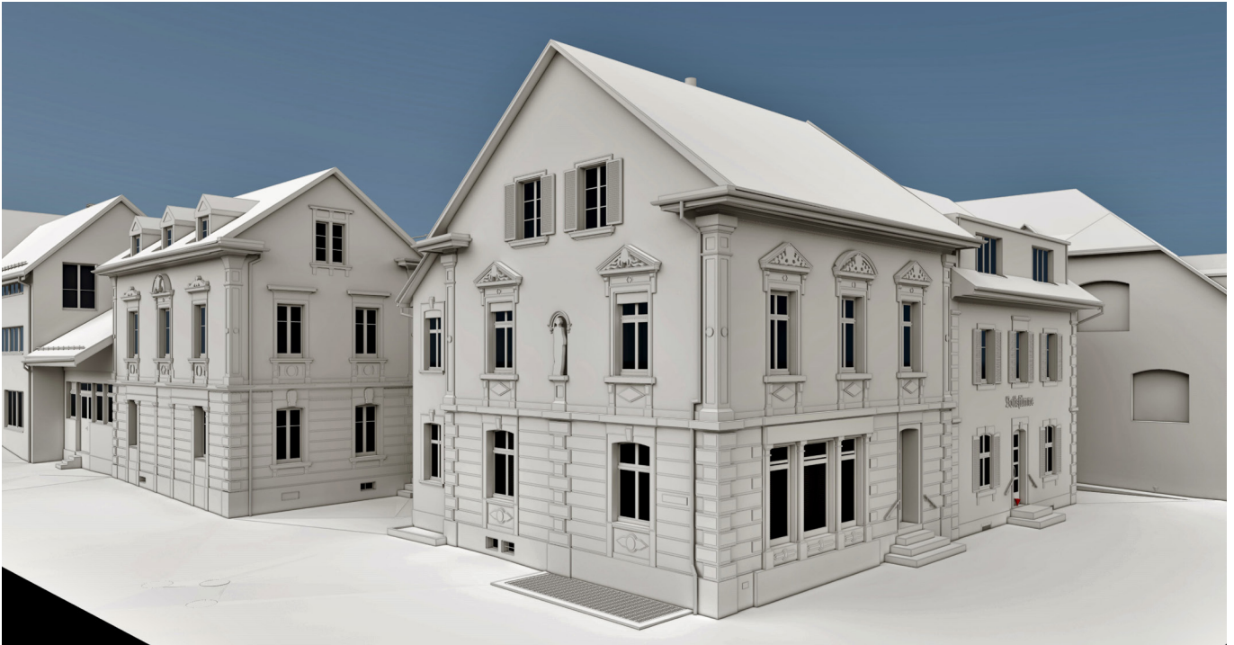
Gesamtansicht des 3D-ArchiCAD-Modells: Modellierung Hauptgebäude (mitte) in LOD200, Nachbargebäude (links und rechts) in LOD100
